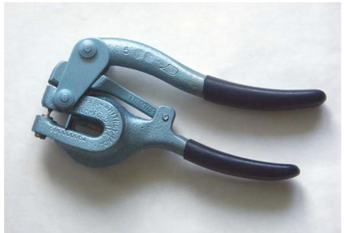
Abb. 14 Handstanze ROPER WHITNEY
