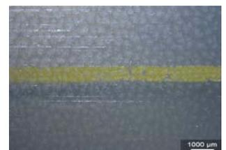
Abb. 32 Netzstruktur durch Verdampfen des Lösemittels
