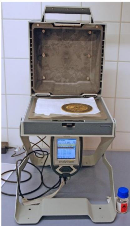
niveaus können nun auf die kernnahen Schalen springen, wodurch Energie frei wird. Diese Energie wird in Form von elementspezifischer Röntgenstrahlung abgegeben und kann detektiert werden.
