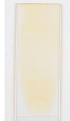
Abbildung 9 Probekörper: Überzugsfilm auf Glasobjektträger, VIS
