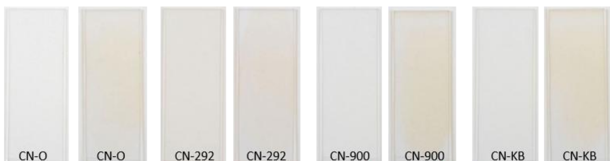
Abbildung 18 Nitrocelluloselack-Probekörper mit den jeweiligen Zusätzen (O-ohne Zusätze, 900- Tinuvin® 900, 292- UV-Stabilisator 292, KB-Kombination Tinuvin® 900/ UV-Stabilisator 292) jeweils im Vorzustand (links) und nach der künstlichen Alterung (rechts), VIS
