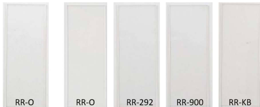
Abbildung 17 Regalrez® 1126-Probekörper mit den jeweiligen Zusätzen (O-ohne Zusätze, 900- Tinuvin® 900, 292- UV Stabilisator 292, KB-Kombination Tinuvin®900/ UV Stabilisator 292), v.l.n.r.:1. - Vorzustand 2.-5.-nach der künstlichen Alterung, VIS
