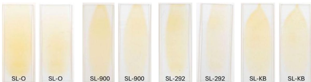
Abbildung 16 Schellack-Probekörper mit den jeweiligen Zusätzen (O-ohne Zusätze, 900- Tinuvin® 900, 292- UV-Stabilisator 292, KB-Kombination Tinuvin® 900/ UV-Stabilisator 292) jeweils im Vorzustand (links) und nach der künstlichen Alterung (rechts), VIS
