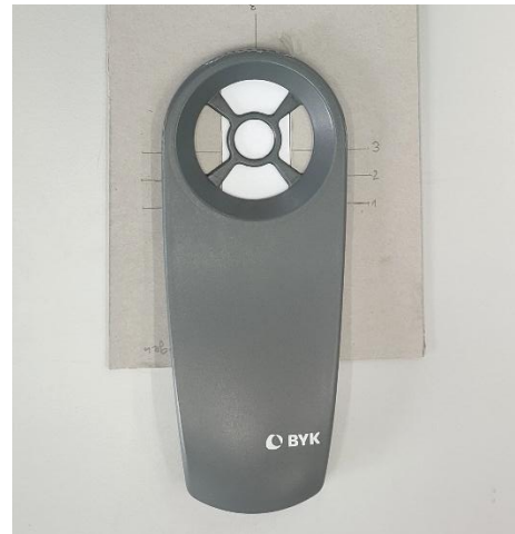
Abbildung 11 Schablone mit Führungshilfe des Farbmessgerätes, VIS
