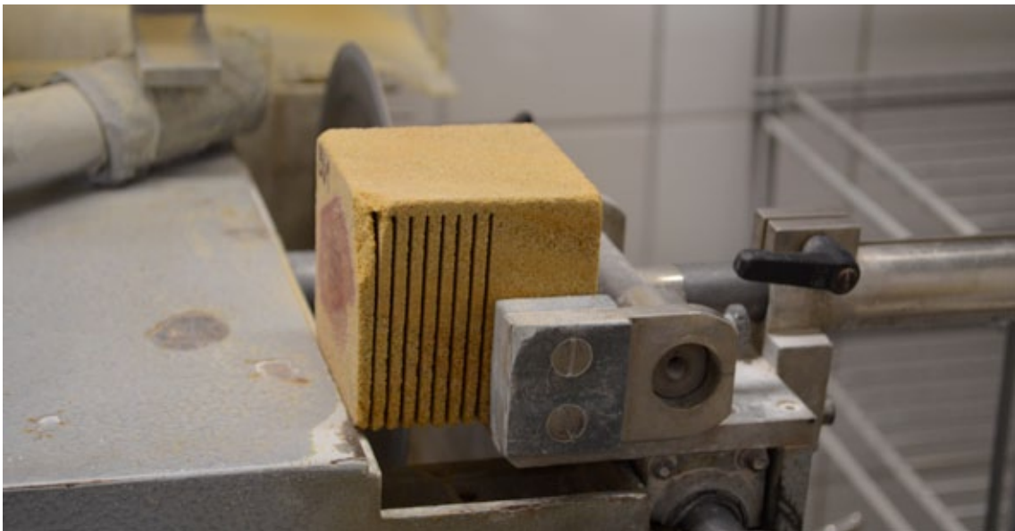
Abb. 21: Begrenzter Ausschub der Aufnahme aufgrund der Probekörperdimensionen
