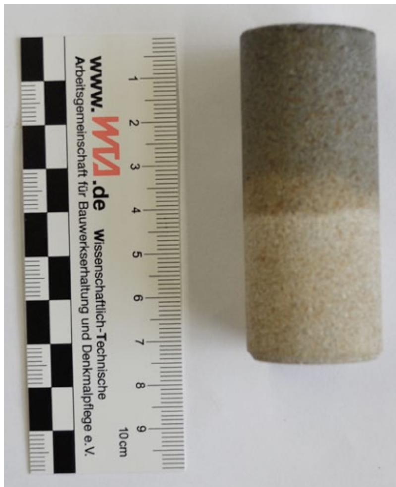
Abb. 56: Chromatographieeffekt an Leistädter Sandstein
