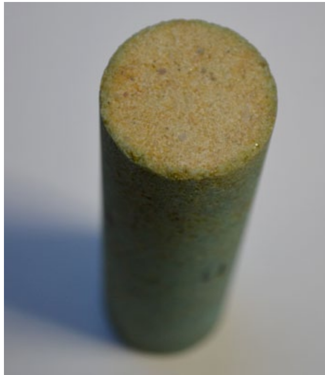
Abb. 57: Anreicherung von Tetraamminekupfersulfat an der Bohrkerndoberfläche
