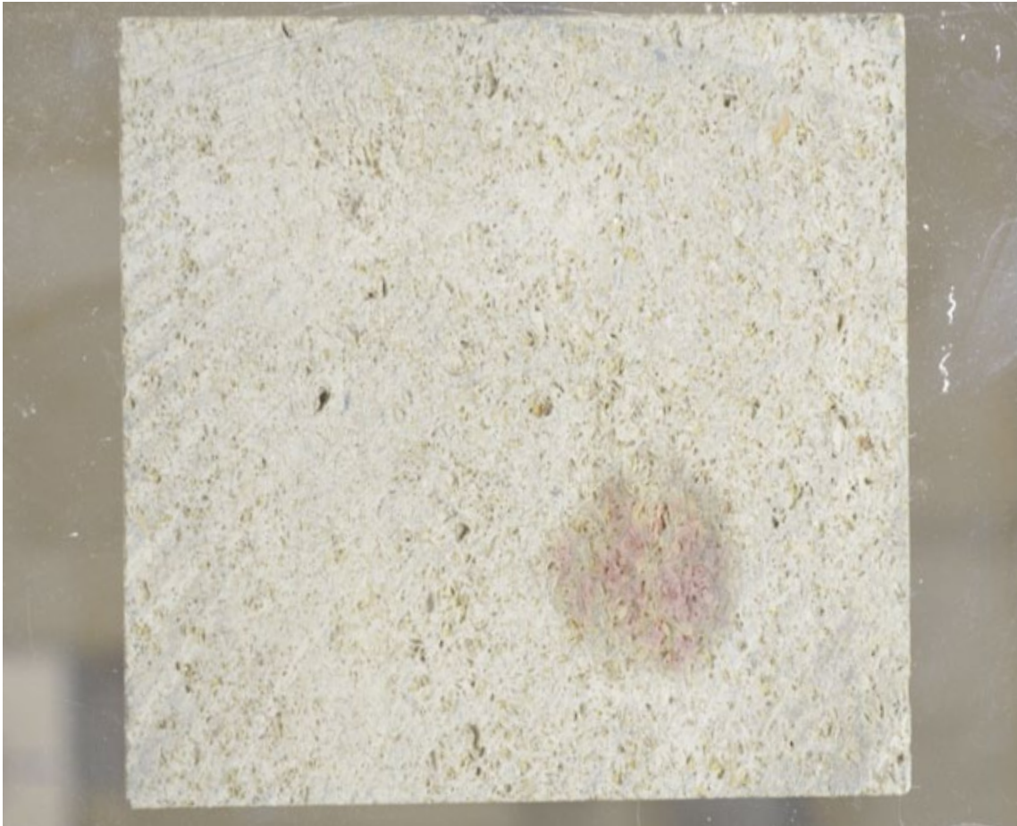
Abb. 53: Nachsaugen an Krenzheimer Muschelkalk. Der Durchfeuchtungshorizont verfärbte sich erst etwa 20-30 Minuten schwach rosa.
