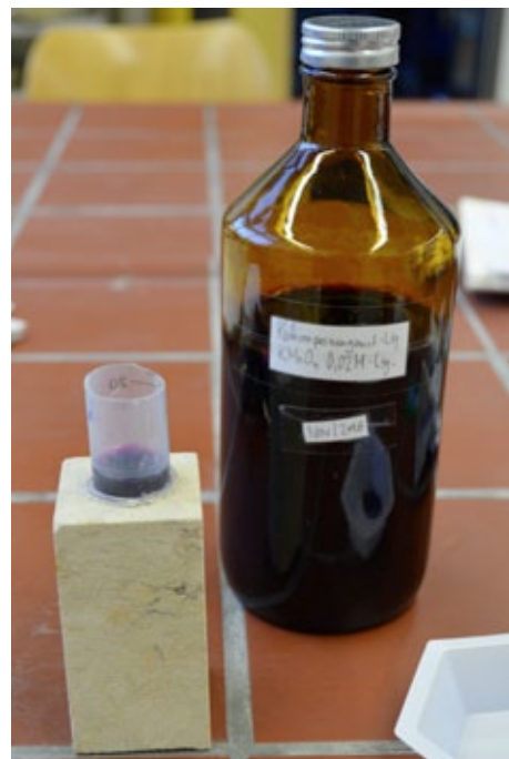
Abb. 6: Mit Plastic-fermit® befestigtes Kunststoffröhrchen auf Cottaer Sandstein, darin KMnO_4 -Lösung
