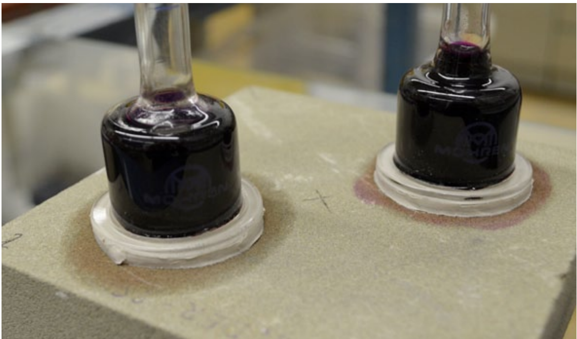
Abb. 52: Chromatographieeffekte an Abtswinder Sandstein, unten links: 0,02M Lösung \text{KMnO}_4 , oben rechts: 0,04M Lösung \text{KMnO}_4
