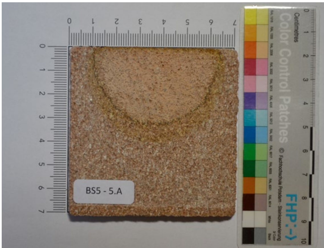
Abb. 58: Nachsaugeffekt an Nürnberger Burgsandstein (Scheibe BS5 - 5.A)
