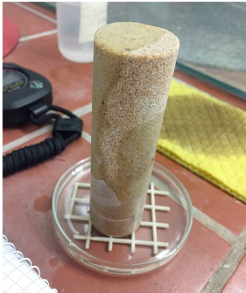
Abb. 47: Durch Schichtung abgegrenzter trockener Teilbereich an Bohrkern P3
