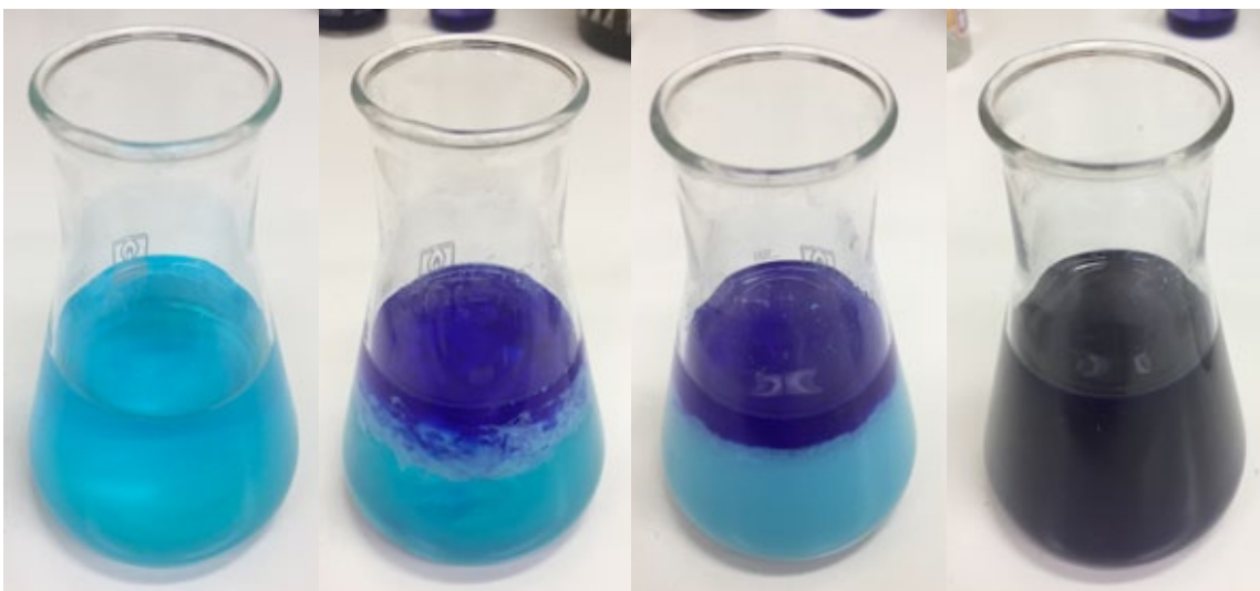
Abb. 54: Kupfersulfatlösung durch Zugabe von Ammoniakwasser zu Tetraamminkupfersulfatlösung
