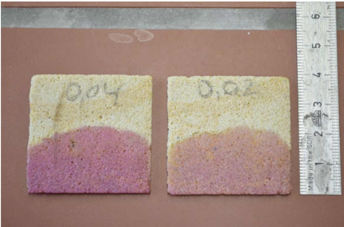
Abb. 50: Vergleichstest \text{KMnO}_4 an Gesteinsplättchen
