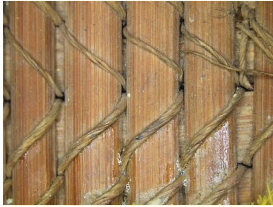
Abb. 16 Holzstäbchen des Trägers (Vorderseite), auf der unteren Bildhälfte sind Klebstoffreste sichtbar, Vergrößerung 10x
