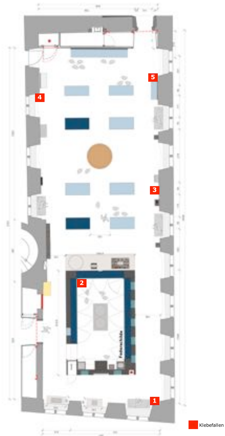
Abb. 90 Grundriss des Ausstellungsraumes der Federschilde mit Vorschlag zur Verteilung von Klebefallen
