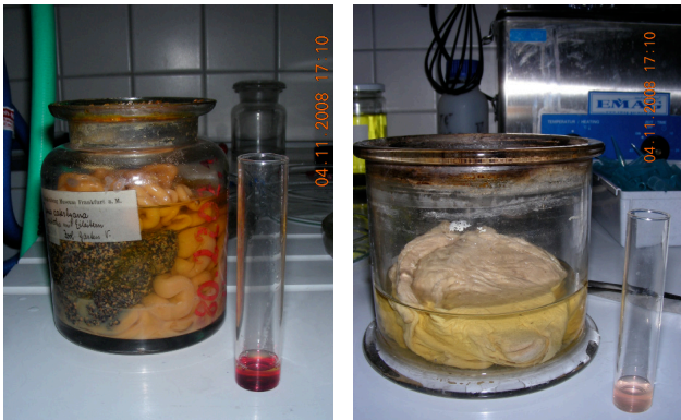
Abb. 7: Farbreaktion bei formalinhaltiger Konservierungslösung (links) und bei alkoholischer Konservierungslösung (rechts) nach etwa 10 Sekunden Reaktionszeit.
