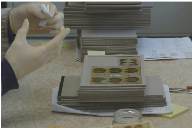
Abb. 30: Säubern und sortieren der Objektträger. Die Reinigung erfolgt mit Ethanol oder Isopropanol, wobei hier jeweils geprüft wird, dass das Reinigungsmittel mit dem Eindeckmittel verträglich ist.
