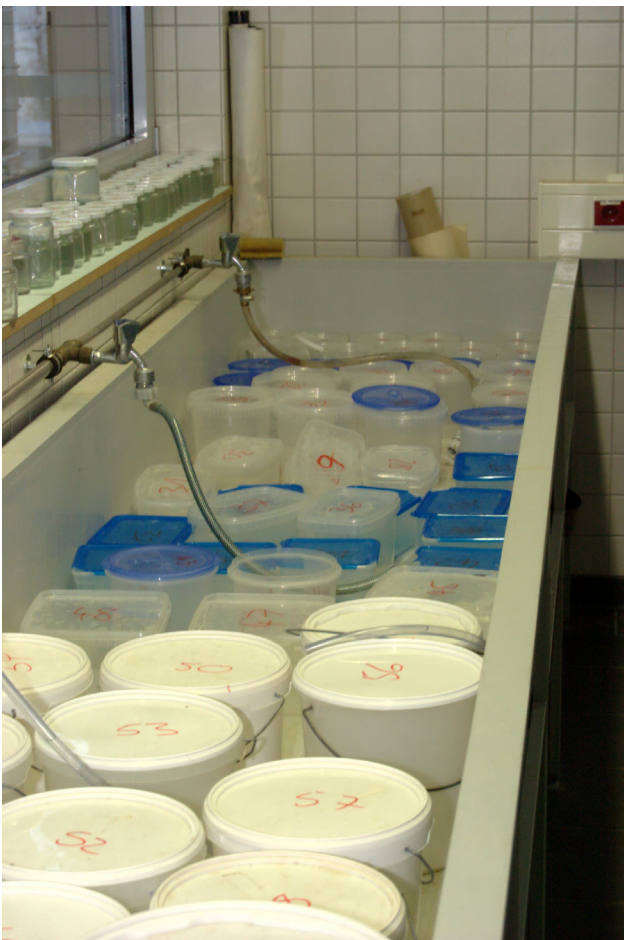
Abb. 11: Die Wässerung der Präparate erfolgt in nummerierten Plastikgefäßen in einer großen Schlammwanne.
