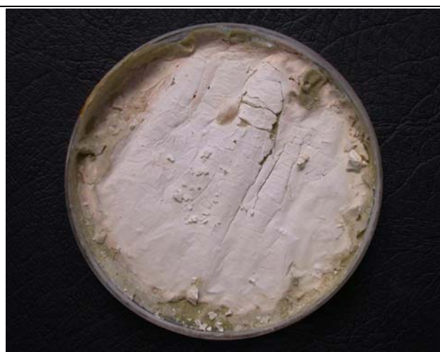
Abb. 74: In den Randbereichen und abgebinde- Bereichen in der Fläche sind deutlich rosafarbene Bakterienkolonien zu erkennen.
