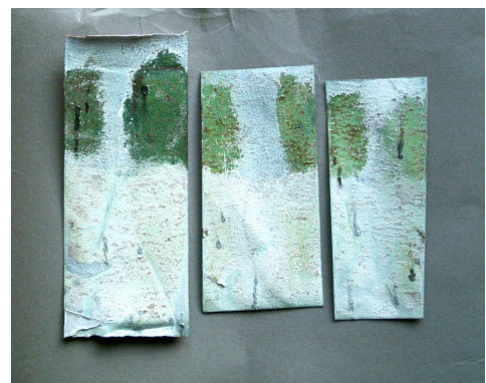
Abb. 297: wie Abb. 296, mit Kunstharzlack- Besprühung, nach Abnahmeversuchen
