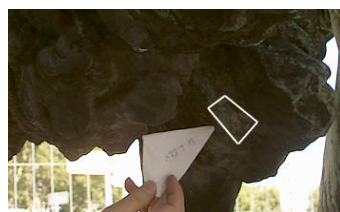
Abb. 192: Probe XRD-T13, Löwe-Mähne, nicht direkt bewitterter Bereich, horizontal und vertikal, Kruste
