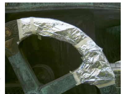
Abb. 211: Versuchsfläche 1 zur Abnahme des Schutzüberzuges; Kompressen während der Einwirkzeit, Abdeckung mit Alu-Folie
