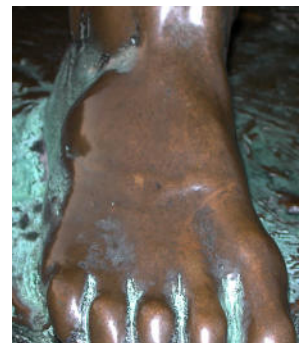
Abb. I44: Jüngling vor dem Theseustempel, Volksgarten, Wien I, Detail Fuß: Die Bildung einer grünen Patina ist durch ständiges Berühren nicht möglich, eine Auswirkung vor allem von Handschweiß
