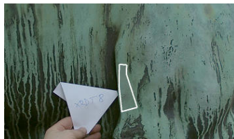
Abb. 187: Probe XRD-T8, Löwin 3, direkt bewitterter Bereich, vertikal, Grünpatina
