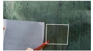
Abb. 182: Probe XRD-T3, Löwin I, direkt bewitterter Bereich, originale Gußflicke, vertikal, braungrüne Patina
