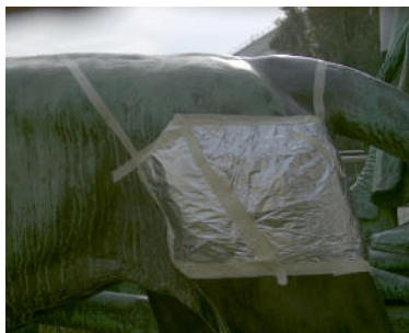
Abb. 211: Versuchsfläche 1 zur Abnahme des Schutzüberzuges; Kompressen während der Einwirkzeit, Abdeckung mit Alu-Folie
