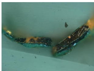
Abb. 226: MA-G-3, LM, Anfärbung auf Öl mit Sudan- Schwarz, pol. Licht, 200-fach
