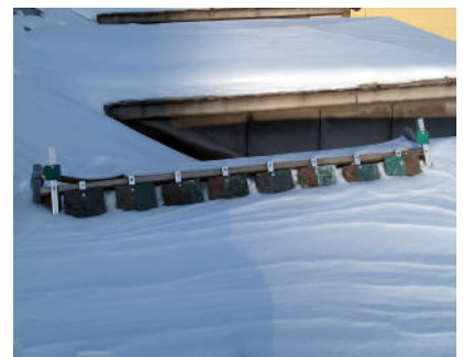
Abb. 279: Expositionsgestell „Z“ in Wien I, Salzgries, Beginn 1. Mai 2002, Aufnahme Januar 2003
