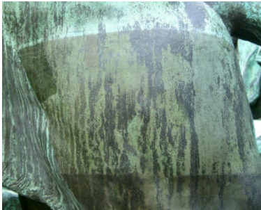
Abb. 215: Testareal I zur Abnahme des Konservierungsüberzuges mittels Gel
