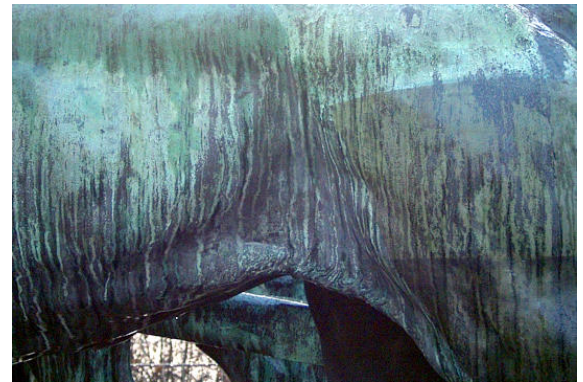
Abb. 294: MA-M, Plinthe: Unterschiedliche mikroklimatische Bereiche an der Oberfläche der Bronzeplastik, hier durch Eis
