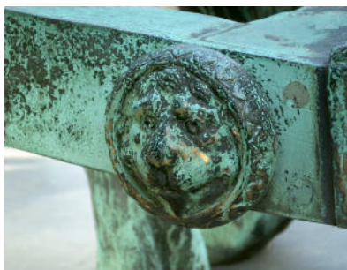
Abb. 106: MA-M, Thronwagen, Verbindungsnahat zwischen Zugstange und Fusskissen, Schraubbolzen für die Verbindung am Umriss erkennbar
