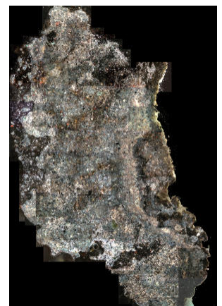
Abb. 135: Querschliff einer Schmutzkruste vom MA-M, Vergrößerung 20-fach 280
