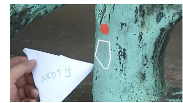
Abb. 188: Probe XRD-T9, Löwin 2, direkt bewitterter Bereich, vertikal, Grünpatina
