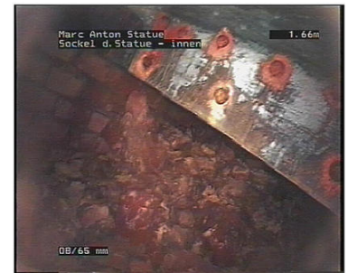
Abb. I53: MA-M, Innenbereich Plinthe, Endoskopieaufnahme
