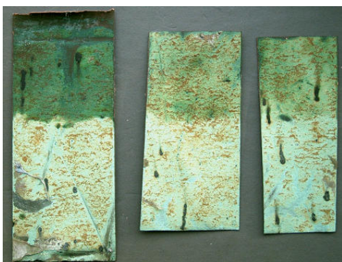
Abb. 296: Kupferplättchen mit Brochantit-Patina, zum Teil mit Coating überzogen
