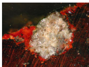
Abb. 178: Probe MA-I, Querschliff, LM, 250-fach: Lochfraß
