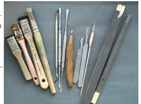
Abb. 298: Werkzeuge zur mechanischen Oberflächenreinigung
