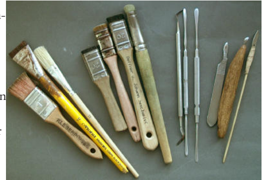
Abb. 299: Werkzeuge zur Reinigung der Blattvergoldung
