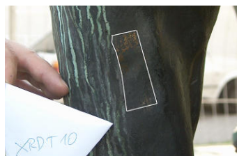
Abb. 189: Probe XRD-T10, Löwin 2, nicht direkt bewitterter Bereich, vertikal, dunkler Bereich
