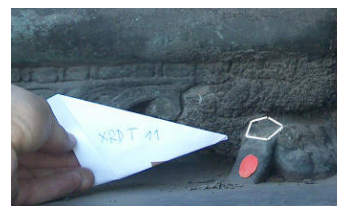
Abb. 190: Probe XRD-T11, Wagen-Fußpolster, nicht direkt bewitterter Bereich, horizontal und vertikal, Kruste
